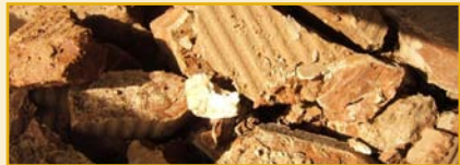
Fig. 38 Lodos residuales con alto contenido en hierro
