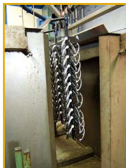
Fig.11 Túnel de secado por aire
