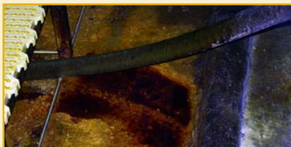
Fig. 21 Goteos procedentes de un baño de cromo decorativo
