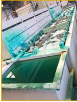
Fig. 57 Cuba de recuperación de baño de níquel
